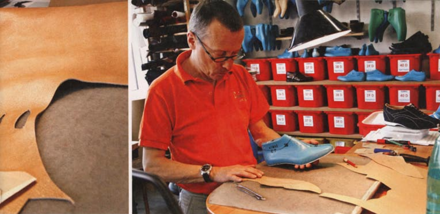
FABRICATION. Un programme informatique définit la largeur et la longueur de la chaussure droite et gauche. La manufacture va utiliser prioritairement le coupon de box-calf de première qualité, mis en œuvre dans une tannerie française.
